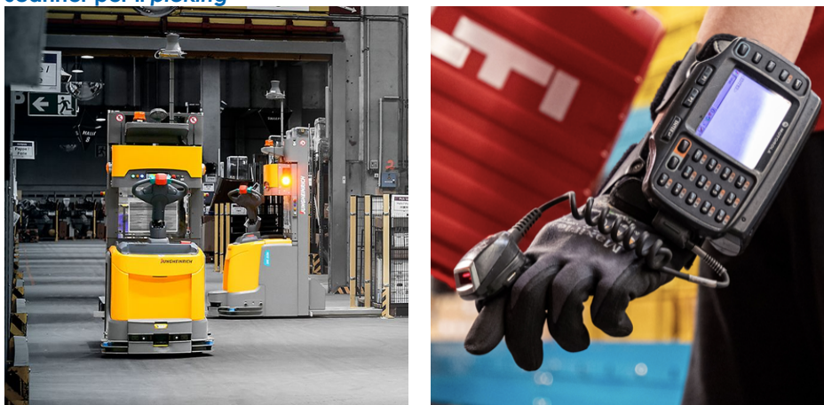
Figura 31 – Alcuni esempi di tecnologia per la logistica: sollevatori a forche senza conducente e uno scanner per il picking
